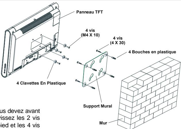
1. Pour installer la TV TFT sur le mur, vous devez avant tout retirer l'assemblage du pied. Dévissez les 2 vis qui attachent la partie supérieure du pied et les 4 vis qui attachent le pied au panneau TFT et retirez l'assemblage du pied du panneau TFT.
