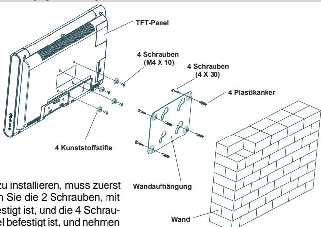
1. Um das TFT-TV-Gerät an der Wand zu installieren, muss zuerst der Standfuß entfernt werden. Lösen Sie die 2 Schrauben, mit denen die obere Fußabdeckung befestigt ist, und die 4 Schrauben, mit denen der Fuß am TFT-Panel befestigt ist, und nehmen Sie den Standfuß vom TFT-Panel ab.
