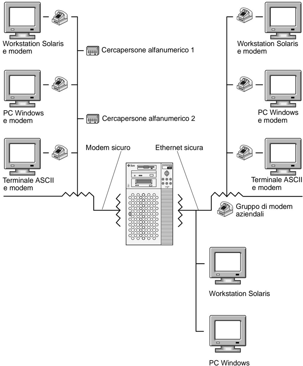
FIGURA 1-2 Percorsi di avviso remoto di RSC
