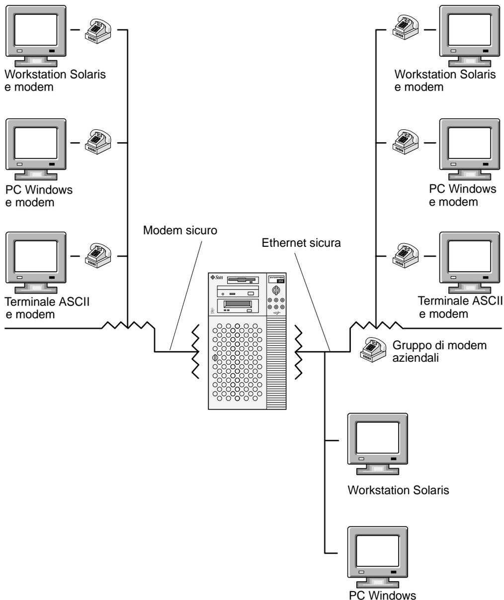
FIGURA 1-1 Percorsi di accesso remoto a RSC
