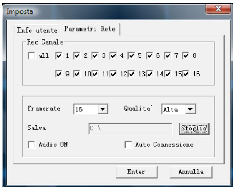
Tramite questa schermata è a questo punto possibile effettuare le seguenti operazioni: abilitare il sistema Audio per l'ascolto in diretta e per la registrazione, stabilire i canali che si desidera registrare sul computer in uso e la relativa destinazione.
