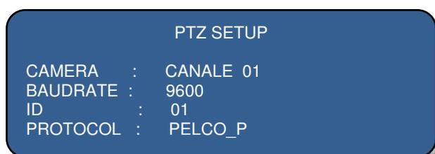
Per attivare/disattivare il controllo PTZ premere il tasto PTZ sul telecomando o, solo per i modelli 8 e 16 canali, il tasto presente anche sul pannello frontale. Per ulteriori dettagli sul brandeggio e il controllo dell'ottica fare riferimento alla *tabella funzione tasti e al telecomando* (pagine 9-12)
