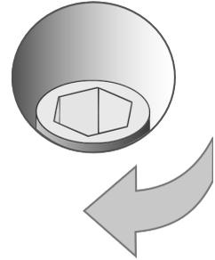
La regolazione verticale dell'obiettivo del Lumis 3D-S può giungere al massimo al 50% dell'altezza dell'immagine. Per esempio, con uno schermo 16:9 di 150 pollici di diagonale, è possibile spostare l'immagine verso l'alto fino a 0.93 m sopra il centro dello schermo (consulta "[Distanze di proiezione](#)" a pagina 41).
