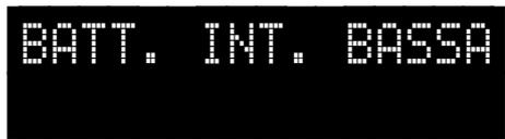
Batteria interna disconnessa: il registratore non può operare.
