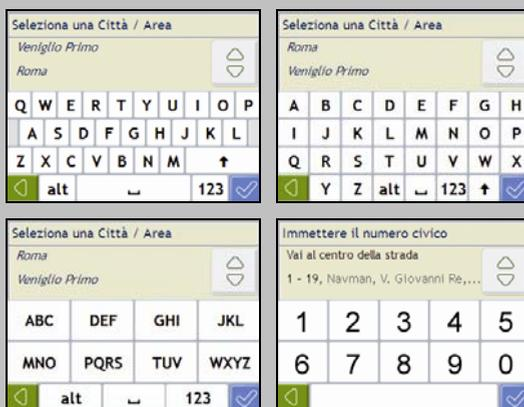
Quando si seleziona un carattere, vengono visualizzati i primi tre risultati. Selezionare
