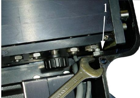
3. Prendete una chiave da 13mm e localizzate la vite con la testa esagonale sulla destra (1).
