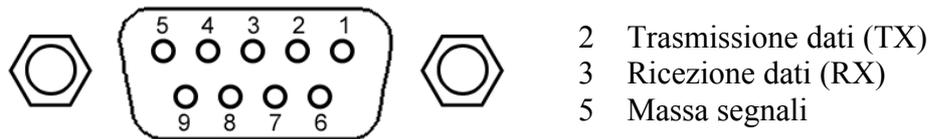
Fig. 5.3: Pinout della porta RS-232.
