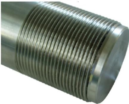
Fig. 4.16: Filetto e imbocco della barra contrappesi.
