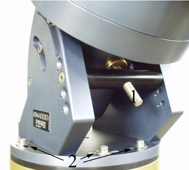
Fig. 4.18: Vite di regolazione della latitudine.
