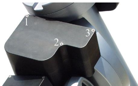
1. Rimuovete le tre viti (1), (2), (3) che bloccano il coperchio che protegge la vite senza fine e il motore e rimuovete il coperchio stesso.
