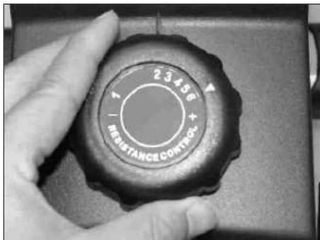
L'« aria » è la principale resistenza del vogatore. A livello 1, la resistenza dell'aria è del 100%. Quando girate la manopola della resistenza in senso orario, iniziate a introdurre gradualmente il sistema magnetico in diversi gradi a seconda dell'impostazione. A livello 8, la resistenza è circa 30% aria e 70% magnetica.
