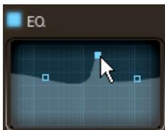
Tenendo premuto il tasto [Alt] e spostando in senso orizzontale è possibile definire l'impostazione Q (o intervallo delle frequenze influenzate) per la banda centrale dell'equalizzatore.
