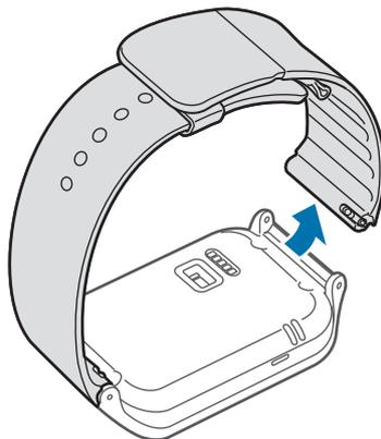
3 Sul nuovo cinturino, inserite un'estremità del perno nella fessura sul lato del Gear.
