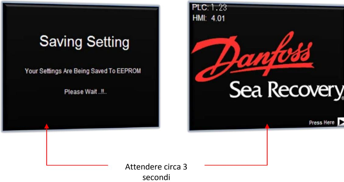
Lo stato dell'accessorio è stato memorizzato e il sistema è adesso pronto per il funzionamento.
