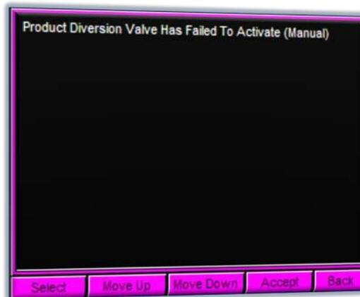
Premendo "Selezionare" si evidenzia il primo elemento di allarme. Premendo "Sposta su", si scorre verso l'alto l'elenco degli allarmi, premendo "Sposta giù" si scorre verso il basso l'elenco degli allarmi. Premendo "Accettare" si cancelleranno le notifiche di allarme elencate.
