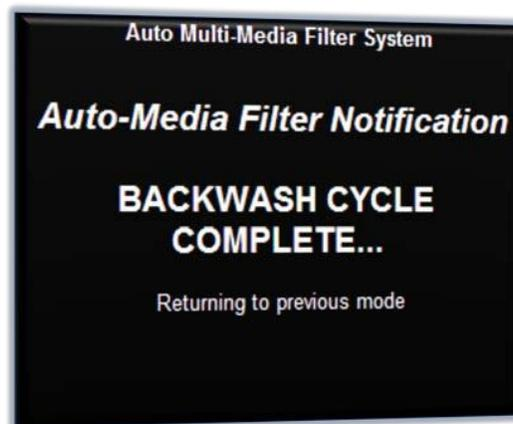
Questa schermata rimarrà visualizzata per circa 4 secondi, dopo questo periodo di tempo, il sistema ritorna al menu principale. Se il sistema di controllo ha avviato il ciclo di controlavaggio in modo automatico, il sistema si avvia di nuovo automaticamente e inserisce di nuovo la modalità di produzione. Altrimenti, l'unità rimane nello stato di stand-by.
