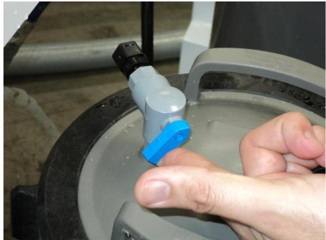
Chiudere la leva della valvola di sfogo premendo verso l'alto per
