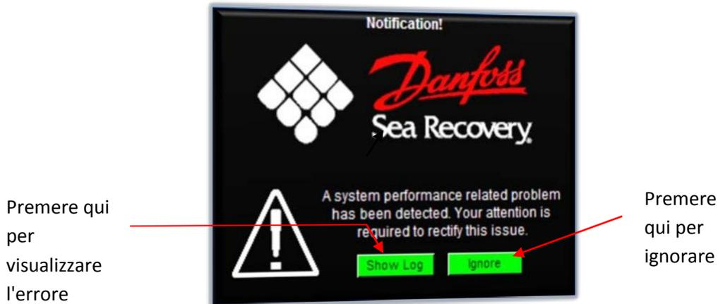
Premendo "Ignora" si cancella l'avviso di esecuzione; premendo "Show Log" si aprirà la finestra di registro dell'avviso di esecuzione sulla quale i dettagli riguardanti il problema rilevato sono mostrati nel modo seguente:
