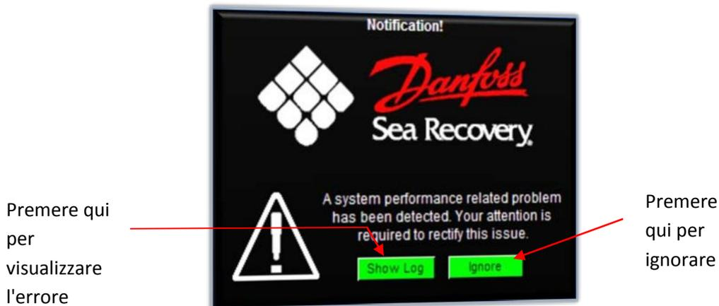
Premendo "Ignora" si cancella l'avviso di esecuzione; premendo "Show Log" si aprirà la finestra di registro dell'avviso di esecuzione sulla quale i dettagli riguardanti il problema rilevato sono mostrati a pagina seguente:
