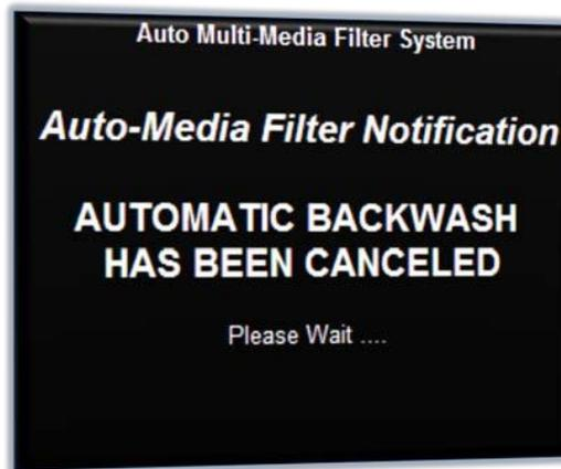
Il sistema di controllo adesso resetta tutte le valvole e riporta il dissalatore in modalità stand-by, una volta completato ciò, il display è posizionato di nuovo al menu principale di funzionamento, come mostrato qui di seguito:
