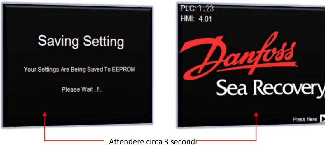
Le impostazioni del sistema multistrato sono state memorizzate e il sistema è adesso pronto per il funzionamento.
