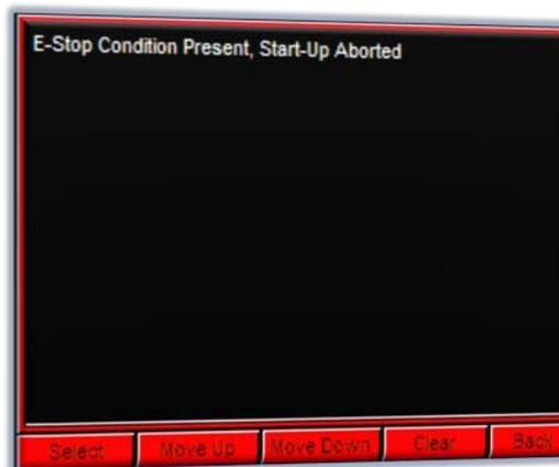
Premendo "Selezionare" si evidenzia il primo elemento di allarme. Premendo "Sposta su", si scorre verso l'alto l'elenco degli allarmi, premendo "Sposta giù" si scorre verso il basso l'elenco degli allarmi. Premendo "Cancellare" si cancelleranno le notifiche di allarme elencate.
