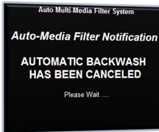
Questa schermata è visualizzata non appena è rilevato un errore del sistema. Una volta completato questo reset del sistema, questa schermata passa alla schermata di avviso di guasto come mostrato qui di seguito:
