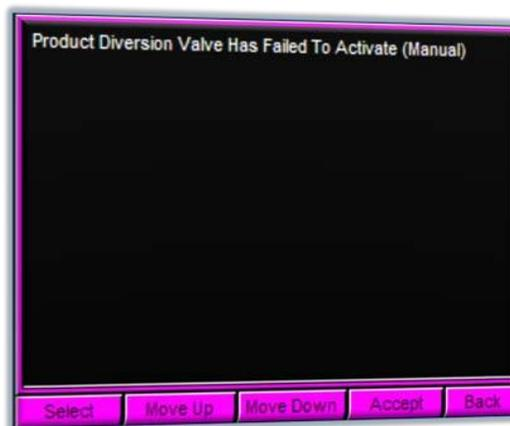
Premendo "Selezionare" si evidenzia il primo elemento di allarme. Premendo "Sposta su", si scorre verso l'alto l'elenco degli allarmi, premendo "Sposta giù" si scorre verso il basso l'elenco degli allarmi.
