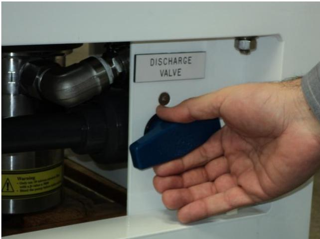
Aprire valvola scarico per drenare alloggiamento filtro
