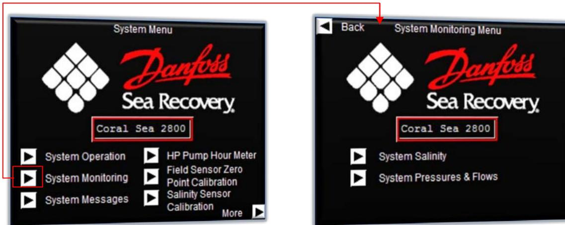
La schermata "Menu monitoraggio del sistema" è visualizzata. Per navigare sulla schermata lettura della pressione e del flusso premere la freccia accanto al testo "Pressioni e flussi del sistema". Premendo questa freccia, si accede alla schermata di monitoraggio della pressione, come mostrato a pagina seguente:
