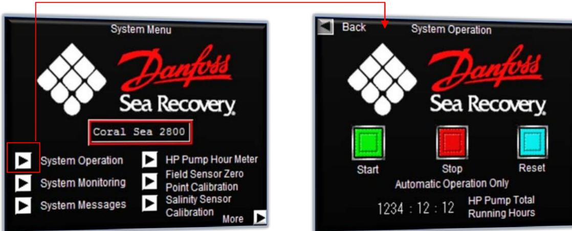
Premendo la freccia nell'angolo in alto a sinistra della schermata del funzionamento del sistema, si ritorna alla prima schermata del menu.
