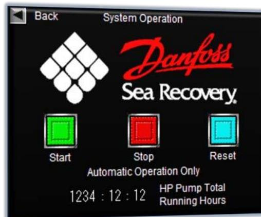
Subito dopo aver premuto il pulsante "Auto-Start", la spia verde inserita sul pulsante inizierà a lampeggiare rapidamente, in questo momento il sistema sta eseguendo i pre-controlli del sistema, se è rilevato un problema, il sistema interrompe l'avvio automatico e visualizza una schermata di notifica dell'errore del sistema che spiega in modo dettagliato il problema (vedere i messaggi di errore critico del sistema), come mostrato a pagina seguente:
