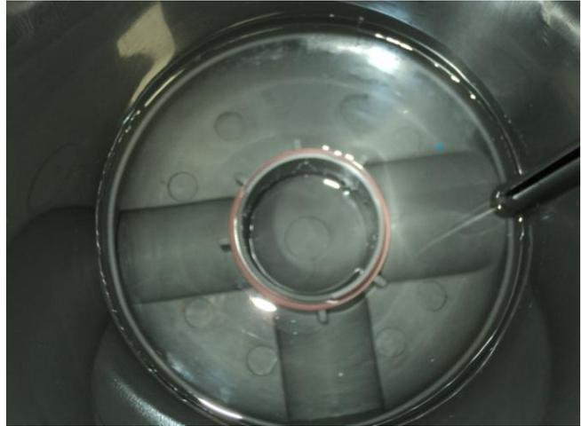
Osservare e controllare le guarnizioni dell'O-ring (superiore e inferiore)
