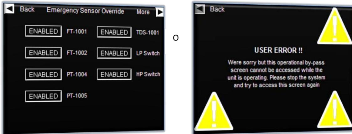
La schermata "Errore dell'utente" apparirà soltanto se il sistema era in funzione nel momento in cui avete effettuato l'accesso al menu by-pass di emergenza. Arrestare il sistema e provare ad accedere di nuovo a questa caratteristica. Se il sistema era off-line, la schermata "Override del sensore di emergenza" sarebbe stato visualizzato.
