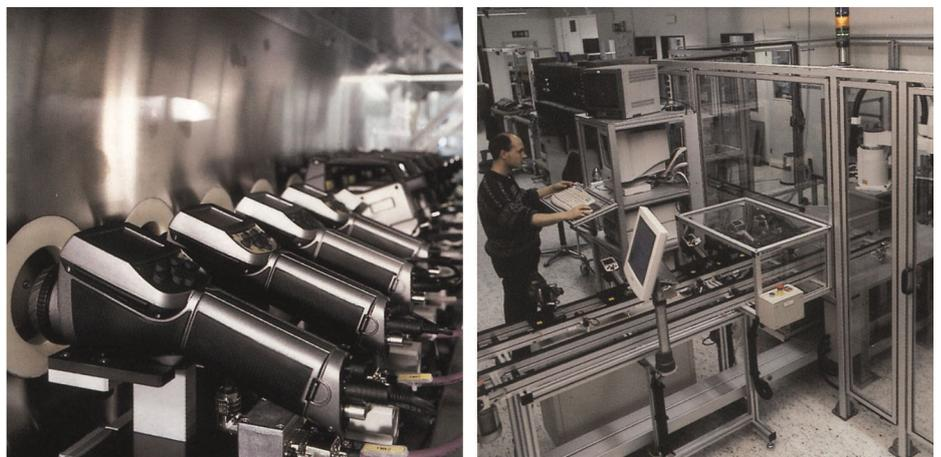
**Figura 14.5** SINISTRA: collaudo delle termocamere ad infrarossi nella camera climatica; A DESTRA: Robot per il collaudo e la calibrazione delle termocamere
