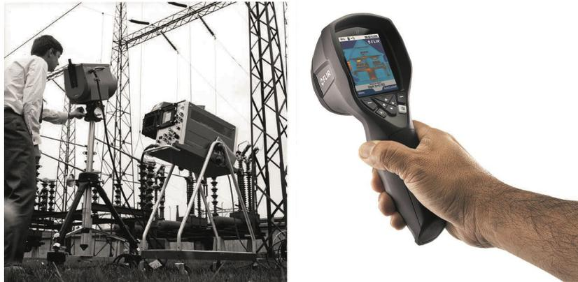
**Figura 14.2** A SINISTRA: Thermovision Modello 661 del 1969. La termocamera pesava circa 25 kg, l'oscilloscopio 20 kg e lo stativo 15 kg. L'operatore inoltre doveva procurarsi un gruppo elettrogeno da 220 VCA e un contenitore da 10 litri con azoto liquido. Alla sinistra dell'oscilloscopio è visibile l'attacco Polaroid (6 kg). A DESTRA: Flir i7 del 2012. Peso: 0,34 kg, batteria inclusa.
