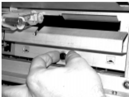
Figura 4-53 Fissaggio della lastra
