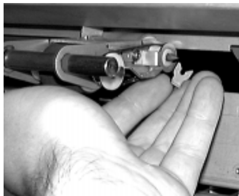
Figura 4-43 Rimozione della graffa del rullo superiore
