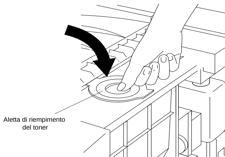
Figura 4-4 Chiusura dell'alletta di riempimento del toner
