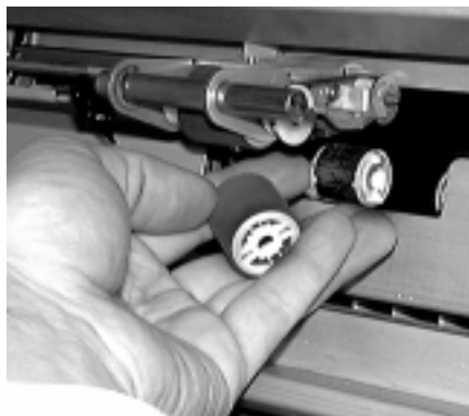
Figura 4-42 Rimozione dei rulli inferiori dall'albero
