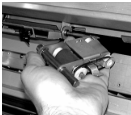
Figura 4-44 Rimozione del gruppo dei rulli superiore
