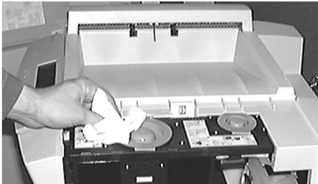
Figura 5-1 Pulizia dell'area del serbatoio del toner
