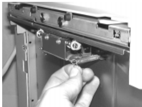
Figura 4-70 Installazione delle molle di ritenuta
