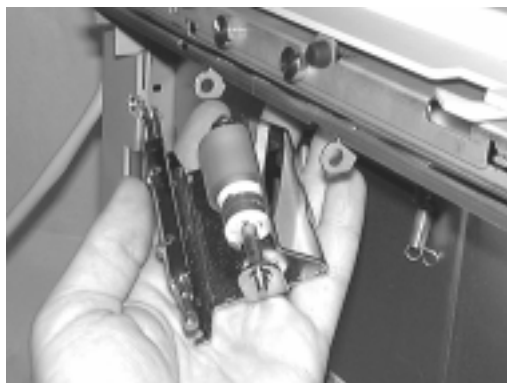
Figura 4-59 Rimozione del gruppo dei rulli inferiore
