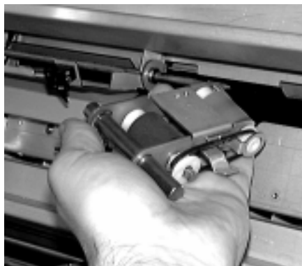
Figura 4-51 Installazione del gruppo dei rulli superiore
