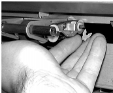
Figura 4-52 Installazione della graffa del rullo superiore
