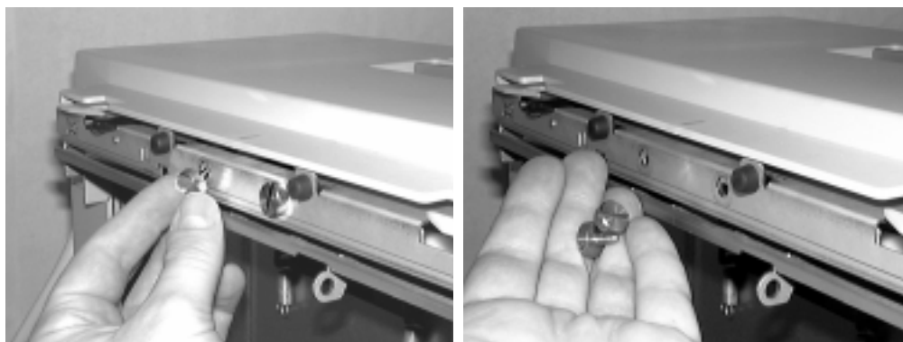
Figura 4-61 Svitare le viti a testa piatta e rimuoverle
