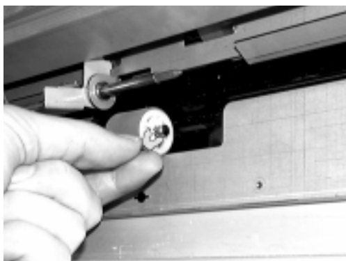
Graffa blu posizionata sull'albero del rullo inferiore
