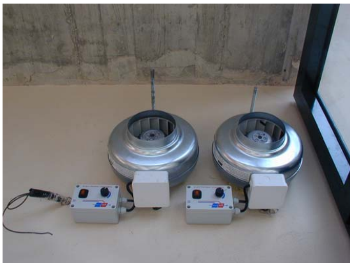
I ventilatori che prelevano l'aria dalla serra
