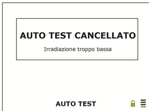
Il test può fallire se l'irradiazione è insufficiente poiché l'inverter non è in grado di alimentare corrente elettrica nella rete di distribuzione. Riavviare il test in un secondo momento.
