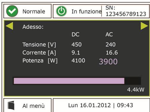
Vengono visualizzati i valori numerici della corrente, tensione e potenza FV (CC) e di alimentazione (CA). La potenza di uscita istantanea viene visualizzata sotto forma di grafico a barre.
