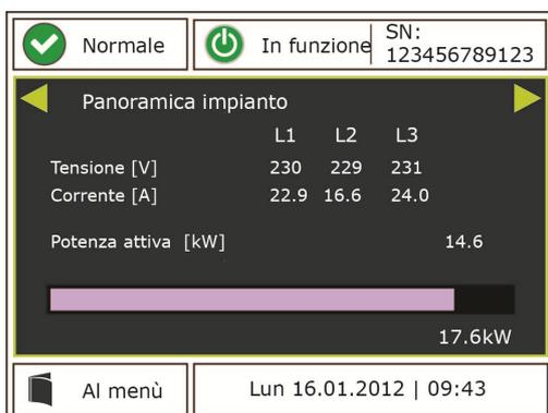
Vengono visualizzati i valori numerici della corrente FV (CC) e di alimentazione (CA), tensione e potenza attiva ed apparente per ciascuna fase relativi all'impianto. La potenza di uscita istantanea viene visualizzata sotto forma di grafico a barre.
