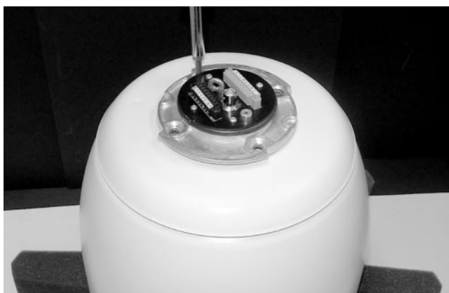
Foto 1D Chiudere la piastra superiore
