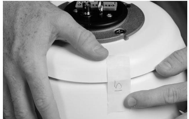
Foto 1E Annotare l'indirizzo della telecamera
