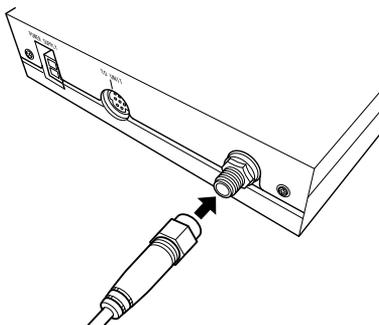
b. Ruotare il connettore del cavo.
