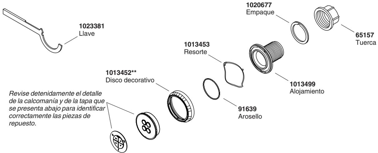
Revise detenidamente el detalle de la calcomanía y de la tapa que se presenta abajo para identificar correctamente las piezas de repuesto.
