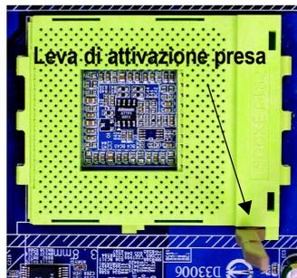
1. Spingere verso l'alto la levetta CPU fino ad un angolo di 90 gradi.
