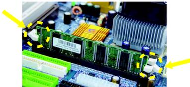
3. Chiudere i fermagli di plastica su entrambi i lati delle prese DIMM per bloccare il modulo DIMM. Invertire le fasi d'installazione quando si desidera rimuovere i moduli DIMM.
