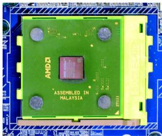
1. Premere verso il basso la leva della presa CPU ed ultimare l'installazione della CPU.
