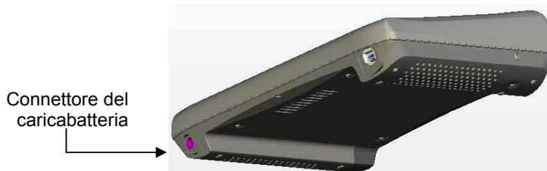
Per caricare le batterie è necessario utilizzare il caricabatterie incluso nella confezione. **NON UTILIZZARE ALTRI ADATTATORI.** L'indicatore diverrà verde dopo pochi minuti di carica. Le batterie saranno completamente cariche quando la spia verde diverrà fissa. Per caricare completamente le batterie occorrono 5 ore. L'adattatore può rimanere collegato anche quando Allora è già completamente carico.
