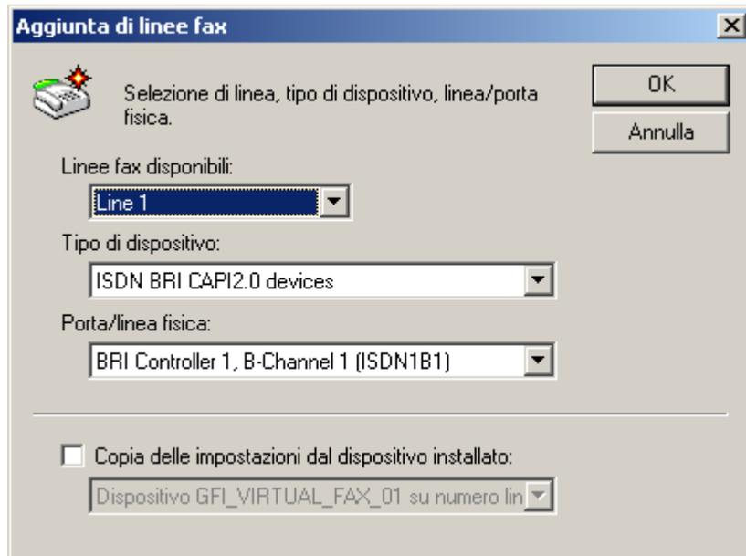
Figura 31 - Aggiunta di un canale ISDN
