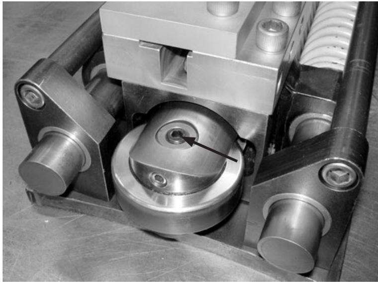
*Figura 4-2. Rimuovere il tappo e installare un ingrassatore per ingrassare la ruota di copiatura. Dopo aver ingrassato la ruota, rimuovere l'ingrassatore e richiudere il tappo.*
