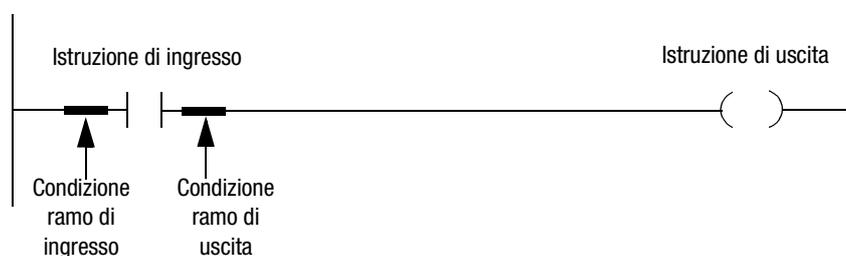
Se la condizione di ingresso del ramo per un'istruzione di ingresso è vera, il controllore valuta l'istruzione ed imposta la condizione del ramo di uscita in base ai risultati dell'istruzione. Se l'istruzione è vera, la condizione del ramo di uscita è vera; se l'istruzione è falsa la condizione del ramo di uscita è falsa.
