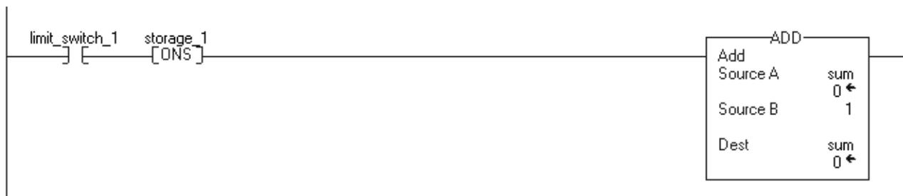
Questo ramo non ha alcun effetto in una scansione in cui *limit\_switch\_1* è azzerato o *storage\_1* è impostato. Nelle scansioni in cui *limit\_switch\_1* è impostato e *storage\_1* è azzerato, l'istruzione ONS imposta *storage\_1* e l'istruzione ADD fa incrementare il valore *sum* di 1. Fino a quando *limit\_switch\_1* rimane impostato, il valore *sum* rimane lo stesso. Il *limit\_switch\_1* deve nuovamente passare da zero ad uno affinché il valore *sum* possa essere incrementato di nuovo.
