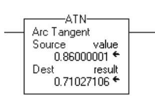
Se è abilitata, l'istruzione ATN calcola l'arcotangente di *value* ed inserisce il risultato in *result*.
