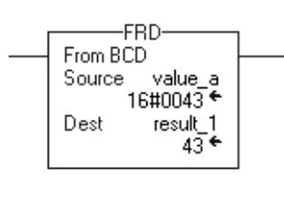
Se è abilitata, l'istruzione FRD converte il *value\_a* in un valore decimale ed inserisce il risultato in *result\_1*.
