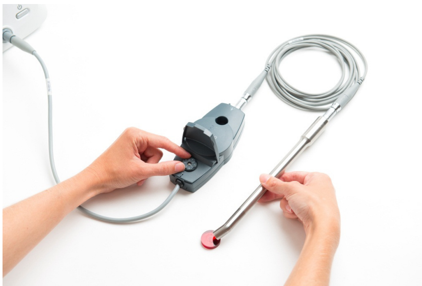
Sopra: esempio di procedura di determinazione del picco in cui viene utilizzata una sorgente di controllo cobalto 57.
