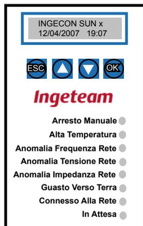
Negli inverter Ingecon® Sun è incorporato un insieme «Display + Tastiera» per la comunicazione con l'installatore e con l'utente.
