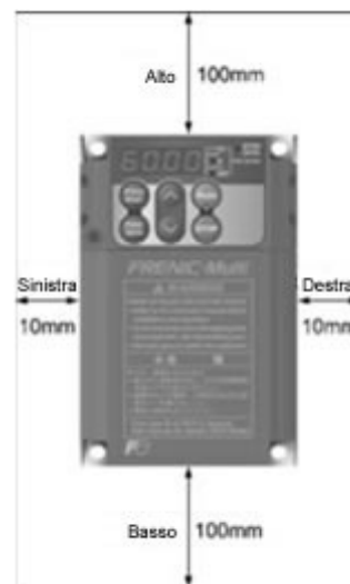
Figura 3.1 Direzione di montaggio e distanze richieste
