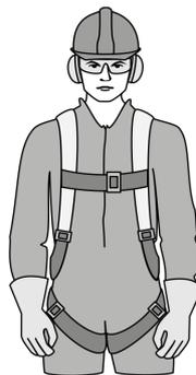
Quando il personale esegue lavoro di ispezione o manutenzione in altezza, deve seguire le procedure di protezione contro le cadute, secondo quanto richiesto dai regolamenti locali. Le prassi e i dispositivi di protezione anticaduta servono a proteggere il personale al lavoro sull'attrezzatura e attorno ad essa contro l'esposizione al rischio di cadute.
