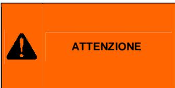
Prima di effettuare qualsiasi collegamento elettrico, l'alimentazione deve essere su OFF e interrotta. Seguire le procedure di lockout-tagout in conformità con le norme locali. Fare riferimento al capitolo "Procedura di Lockout - Tagout (esclusione e segnalazione)".
