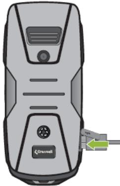
2. Collega il micro connettore USB del cavo nella porta USB. La barra dell'indicatore della batteria inizia a scorrere.
