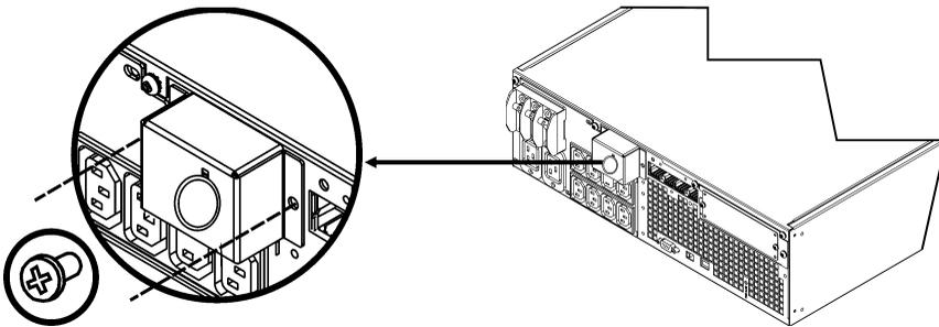
4. Dirigere un filo di sezione 5 mm<sup>2</sup> (10 AWG) attraverso il pannello di accesso e collegare i fili al blocco dei terminali (verde: massa, marrone: vivo, blu: neutro). Utilizzare un fermo tiracavi appropriato (non fornito in dotazione).
