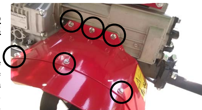
Fig. 12 Carter protezione fresa e viti di fissaggio.
