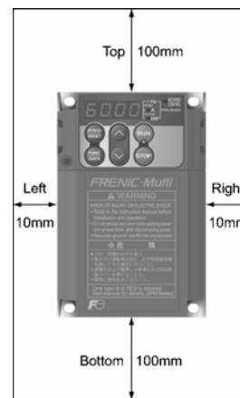
Figura 2.1 Direzione di montaggio e distanze richieste
