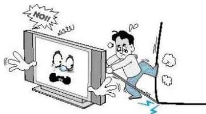
Utilizzare solo prese per la messa a terra o polarizzate. Per ragioni di sicurezza il Monitor è fornito di una presa di corrente alternative polarizzata con un filo più grande dell'altro. Questa presa può essere inserita nell'attacco solo in un modo. Se non si riesce ad inserire la presa provare nella posizione inversa. Se la presa continua a non entrare chiamare un elettricista per far sostituire l'attacco.
