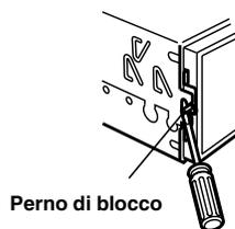
Far entrare il HDA-5460 il più possibile nella plancia di montaggio. Quando l'apparecchio è inserito, verificare che i perni di blocco siano ben assentati nella posizione abbassata. Questo può essere ottenuto premendo fermamente sull'apparecchio mentre si spinge in giù il perno con un piccolo cacciavite. Questo assicura che l'apparecchio sia correttamente bloccato e non fuoriesca accidentalmente dal cruscotto. Installare il pannello anteriore estraibile.
