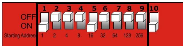
Va sottolineato che le impostazioni degli indirizzi DMX sono la somma dei valori dei dip switch. Un indirizzo DMX standard per un dispositivo Showtec LED Double Scan, a 4 canali, è questo:
