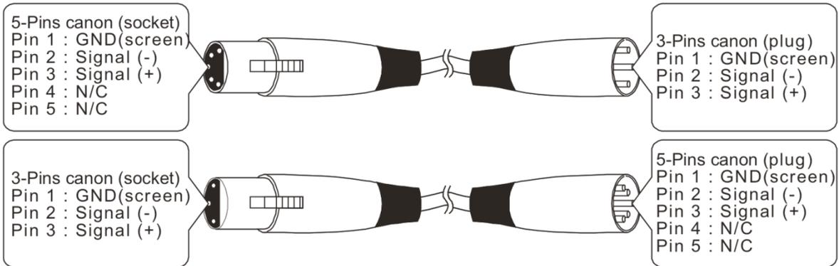
4. Collegare le unità come indicato nella (figura 4). Collegare un cavo di segnale DMX dall'uscita "out" del primo dispositivo DMX alla presa "in" della seconda unità. Ripetere questo processo fino a collegare la seconda, la terza e la quarta unità.
