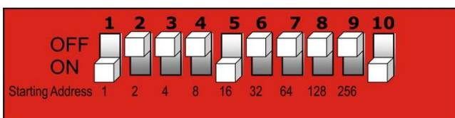
Spiegazione: Dato che ogni unità ha 4 canali, ogni indirizzo aumenta di 4 valori (cfr. Valore indirizzo più sopra).
