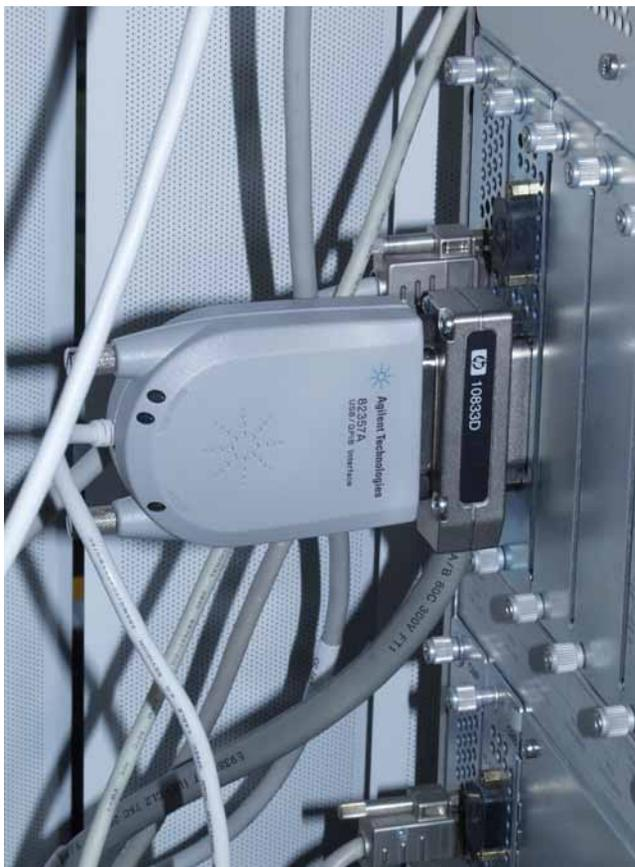
**Figura 23** Interfaccia USB-GPIB 82357A su HP 1090/DAD
