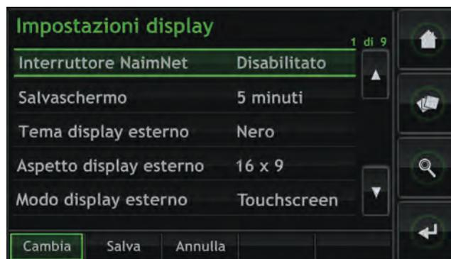
**Interruttore NaimNet:** da selezionare per consentire l'accesso al sistema NaimNet se connesso a UnitiServe. Il tasto NaimNet è presente sul lato destro del display di interfaccia se è disponibile un sistema NaimNet.
