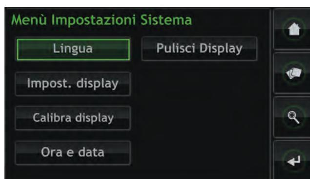
**Impost. display:** consente l'accesso a numerosi parametri di configurazione di UnitiServe e delle sue interfacce con qualsiasi display esterno.
