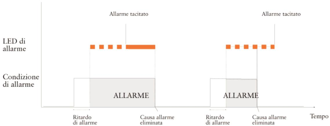
*Indicazione di allarme mediante LED.*
