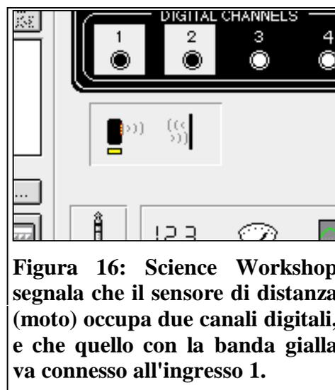
**Figura 16: Science Workshop segnala che il sensore di distanza (moto) occupa due canali digitali, e che quello con la banda gialla va connesso all'ingresso 1.**
