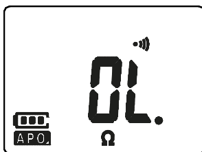
Figura 2-10 Valore continuità circuito aperto sul display
