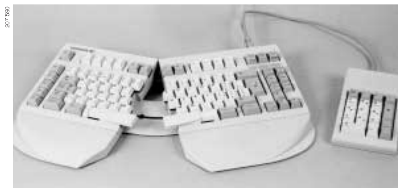
Figure 38, 39 «Tastiera ergonomica» regolabile. Il tastierino numerico separato facilita la digitazione dei numeri.
