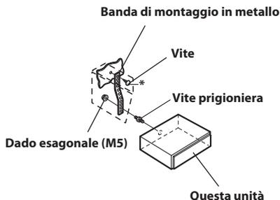
\* Per la vite\*, procurarsi una vite adatta all'ubicazione di installazione nel telaio.
