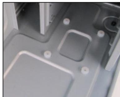
**Nota:** non torcere né serrare eccessivamente le viti del vassoio per unità interna da 3,5 pollici. La compressione delle viti contro le gommine in silicone ridurrà la loro durata e ridurrà o annullerà il loro effetto isolante dalle vibrazioni. Serrare le viti fino a quando non si avverte una resistenza, quindi fermarsi.
