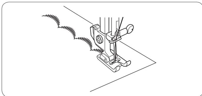
Stabilire la densità corretta del punto eseguendo una cucitura di prova.
