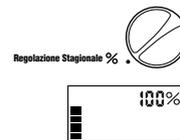
Per visualizzare i nuovi tempi d'irrigazione, basterà ruotare il selettore su **TEMPI D'IRRIGAZIONE**. Il display del tempo d'irrigazione terrà conto della regolazione stagionale.
