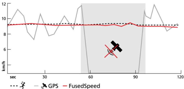
FusedSpeed può essere particolarmente utile quando serve grande reattività nella lettura della velocità durante l'allenamento, ad esempio quando si corre su terreni accidentati o durante l'allenamento intervallato. Se si perde temporaneamente il segnale GPS, ad esempio, Suunto Ambit3 Peak è in grado di continuare a fornire precisi dati di velocità grazie all'accelerometro calibrato GPS.
