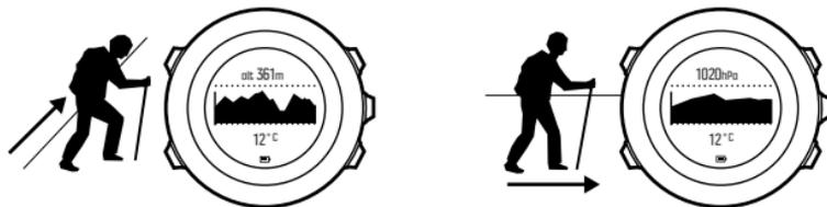
Non è possibile rilevare contemporaneamente le variazioni meteo e le variazioni di altitudine, dato che entrambe causano dei cambiamenti nella pressione atmosferica circostante. Quando necessario, Suunto Ambit3 Peak rileva gli spostamenti in verticale e passa alla rilevazione dell'altitudine. Quando è attiva l'indicazione dell'altitudine, il valore viene aggiornato con un ritardo massimo di 10 secondi.
