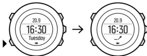
L'indicatore del trend barometrico è composto da due linee che formano una freccia. Ciascuna linea rappresenta un periodo di 3 ore. Un cambiamento della pressione barometrica maggiore di 2
