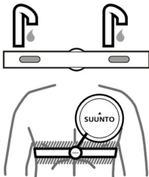
Lo Smart Sensor si attiva automaticamente quando rileva il battito cardiaco.
