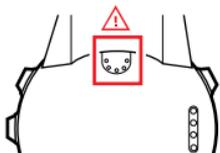
**⚠ ATTENZIONE:** Evitare l'accumulo di polvere, sporcizia o sabbia in prossimità del sensore. Non inserire mai alcun oggetto nelle aperture presenti sul sensore.
