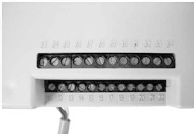
Figura 3: Morsetti di controllo del controllore SMC-Flex
