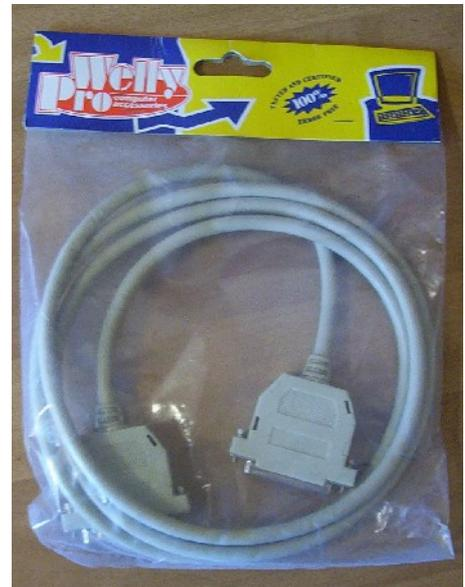
Su alcuni vecchi PC si trova un connettore SUBD25 maschio: questo non va confuso con la porta parallela, che è femmina dal lato PC, trattandosi invece di una porta seriale. Su alcuni vecchi PC si trova un connettore identico a quello della porta parallela, ma si tratta invece di un connettore SCSI esterno; in questa rara eventualità è possibile riconoscere la reale porta parallela osservando a quale scheda di espansione interna del PC è collegata.
