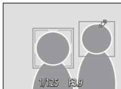
La fotocamera è in grado di rilevare fino a tre volti. Se la fotocamera rileva più di un volto, il doppio bordo viene visualizzato attorno a quello più vicino al centro dell'inquadratura, mentre gli altri volti sono circondati da un bordo singolo.
