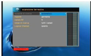
Avete due Opzioni per la ricerca dei canali DVB-T2. Se conoscete i parametri dei canali, scegliete la ricerca manuale e scegliete il conseguente canale RF. Altrimenti utilizzate la ricerca automatica con cui vengono scansionate tutte le frequenze.
