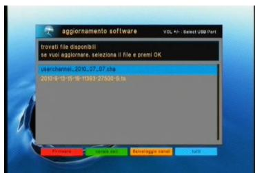
Ciò permette di aggiornare il software di sistema per mantenere la migliore prestazione possibile del MediaBox. Scaricare l'ultimo software dal nostro sito web e copiarlo su una penna USB. Collegare la penna USB ad uno dei connettori USB (anteriore o posteriore) del MediaBox. Il processo di aggiornamento si avvierà automaticamente. Si prega di attendere finché il MediaBox si è riavviato.
