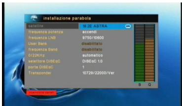
Prima di effettuare la ricerca canali, le opzioni dell'antenna devono essere configurate secondo il vostro sistema
