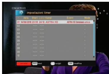
Una finestra aggiuntiva viene aperta la quale mostra i dati nel timer. Se un HDD è collegato la registrazione verrà fatta su di esso. Se non è collegato un HDD il MediaBox cambierà sul canale all'ora programmata.
