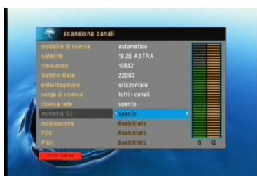
Ci sono due opzioni per la ricerca dei canali trasmessi. Se si conoscono i parametri dei canali, selezionate la modalità di ricerca manuale e inserite i parametri sottomenzionati. Altrimenti utilizzate la modalità di ricerca automatica dove saranno scansionate tutte le frequenze.
