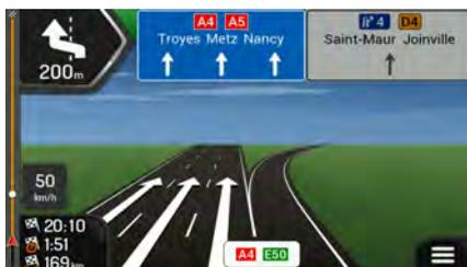
**Causa:** Se ci si sta avvicinando all'uscita di un'autostrada o a un'intersezione complessa e le informazioni necessarie sono disponibili, la mappa viene sostituita da una vista panoramica 3D dell'intersezione. Le corsie da tenere sono indicate da frecce.
